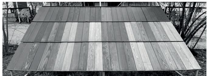
Мы ежегодно проводим испытание доски и защитных масел разных производителей на выгорание и растрескивание. В результате со 100% уверенностью можем рекомендовать масла, проверенные на собственном опыте.
